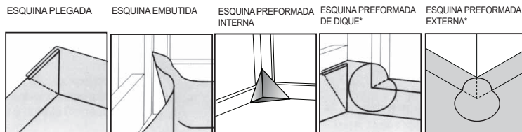
Figura 2. ESQUINAS PLEGADAS, EMBUTIDAS, PREFORMADAS INTERNAS Y EXTERNAS
